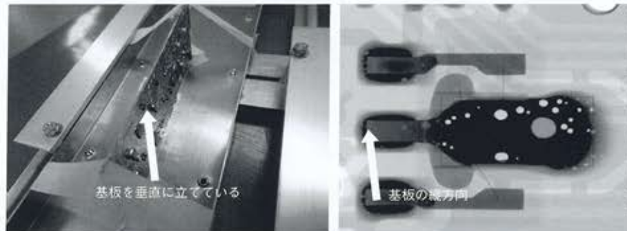
2)【垂直リフローボイド率】 注:ボイドが集まっている、左方向が上面になる
